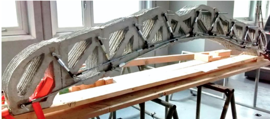
Рисунок 4 – Надруковані порожнисті залізобетонні блоки, зібрані та посилені зовнішньою сталевією арматурою
