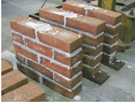
Рисунок 4 – Дослідні призми для визначення міцності цегляної кладки на стиск згідно [3]
