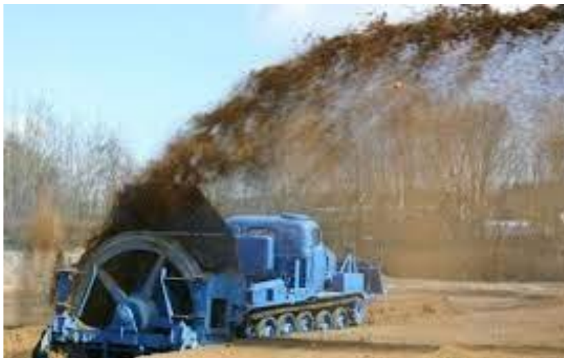
Рисунок. 1. - Застосування роторно-лопатєвого металевих конвеєрів у землерийній машині МДК-2М
