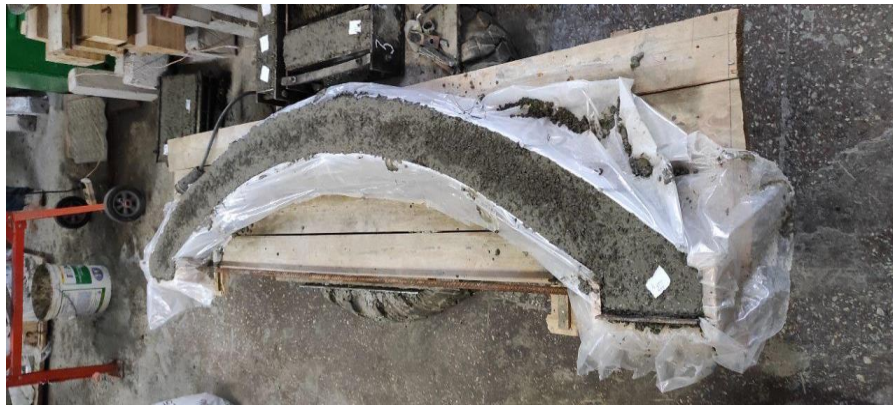
Рисунок 2. Дослідний зразок арки в процесі виготовлення
