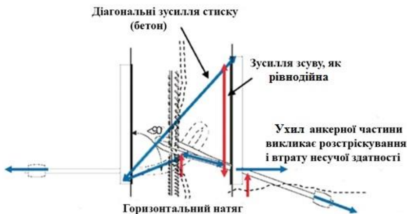
Рисунок 3 – Схема роботи петлі при встановленні з ухилом
